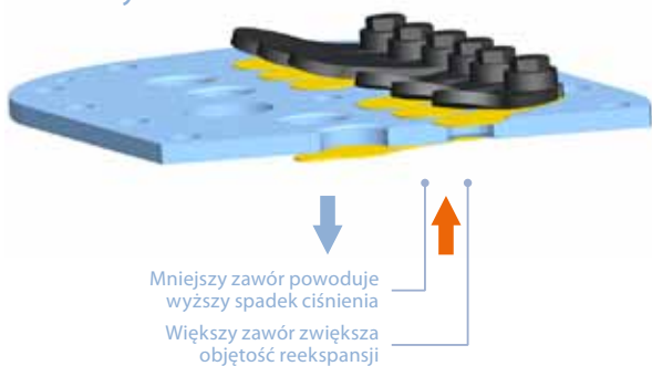
Rys. 6: Zastosowanie zaworu listkowego wymusza dokonanie kompromisu w konstrukcji pomiędzy spadkiem ciśnienia i objętością reekspansji, co powoduje, że nie można uzyskać optymalnej efektywności dla wszystkich czynników chłodniczych i punktów na krzywej eksploatacji. Konieczne jest stosowanie konstrukcji dostosowanej do danego czynnika chłodniczego.
