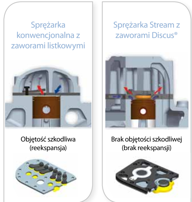
Rys. 2: Kluczowa różnica pomiędzy konwencjonalnymi zaworami listkowymi a zaworami Discus®
